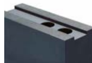
Spannbacke nach der Reinigung Serration after cleaning
