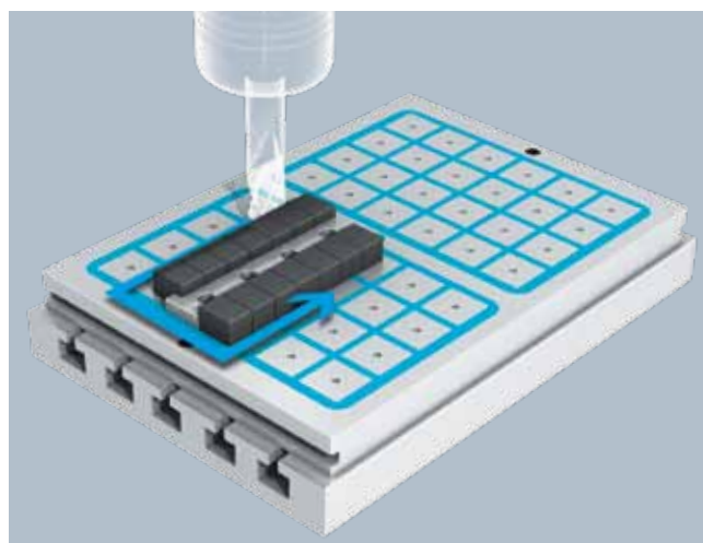
Прямой прижим к Упору Direct clamping against stop position
